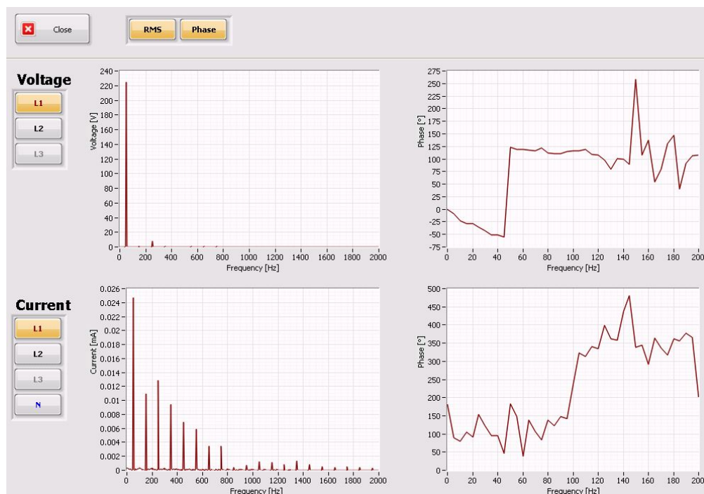
Slika 3.23 Amplitudski i fazni spektar napona i struje faze L1
